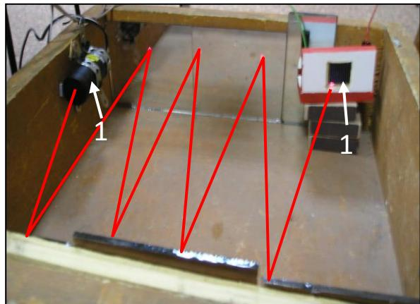
Расстояние от луча верхнего лазера, до плоскости, образуемой лучами нижнего лазера, равно  $(23,0 \pm 0,5)$  см.
